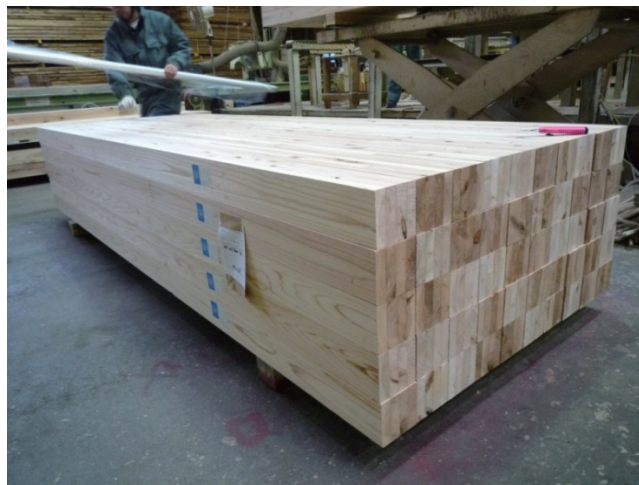
写真2 (23) 2 ラベル貼付後の梱包作業工程 (写真は JAS ラベルを貼付する様子だが、合法ラベルも同様に行われる)
